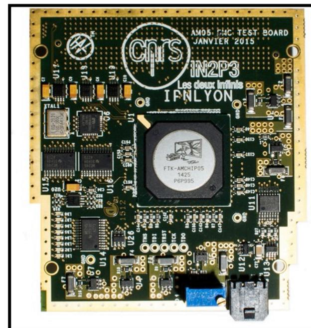
→ Pour le moment, le système est développé hors châssis, avec une carte d'évaluation (Xilinx VC709) et une mezzanine AM réalisée à l'IPNL. Les protocoles de communication entre les différents éléments sont en place, la chaîne complète devrait fonctionner avant la fin de l'année. Premier jalon important vers un démonstrateur plus complexe (2016)
